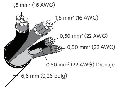
4. Instale el conector disponiendo los cuatro conductores por color y número de acuerdo con el siguiente diagrama. Inserte el cable y luego apriete el tornillo para fijarlo en su lugar.
